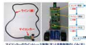
マイコンカーのライトレース制御(左)と自動制御のしくみ(右)
