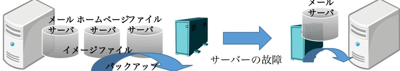
仮想化によりサーバーをイメージファイルとして運用することで、故障時に丸ごとバックしたイメージファイルをコピーするだけでスピード復旧が可能に!!
