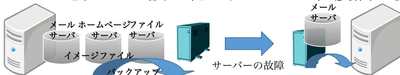
仮想化によりサーバーをイメージファイルとして運用することで、故障時に丸ごとバックしたイメージファイルをコピーするだけでスピード復旧が可能に!!
